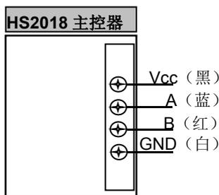
附图 1 HS2018 主控器接口模块接线图
